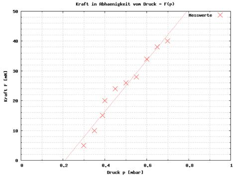
$Ausgleichsgerade: F(p) = 86 \frac{N}{mbar} \cdot p - 18N$  Die Grafik zeigt die Kraft auf die kleine Kreisscheibe in Abhängigkeit von dem dynamischen Druck, der auf die Scheibe wirkt.
