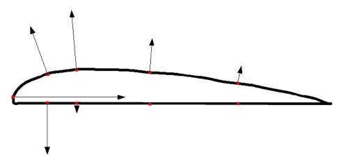
Die Länge der Pfeile ist proportional zum Druck, positiver Druck zeigt in den Flügel hinein, negativer heraus. Die Pfeile stehen senkrecht auf der Oberfläche. Der Druck auf der Tragfläche bei einem Anstellwinkel  $\alpha=20$ :
