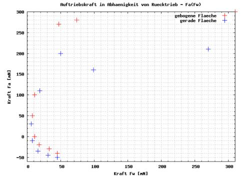
Die Grafik zeigt den Auftrieb in Abhängigkeit vom Strömungswiderstand beider Platten.
