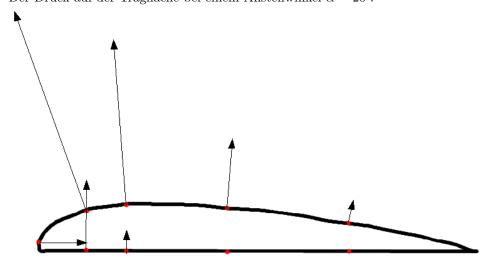
Der Druck auf die Tragfläche bei einem Anstellwinkel  $\alpha=-20$  :
