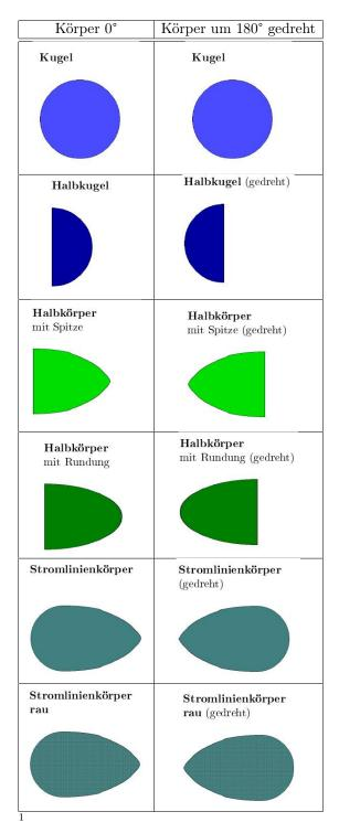
Der Widerstandsbeiwert  $c_w$  hängt sowohl von der Form, als auch von der Richtung zum Luftstrom und der Oberfläche, die ein Körper hat, ab.
