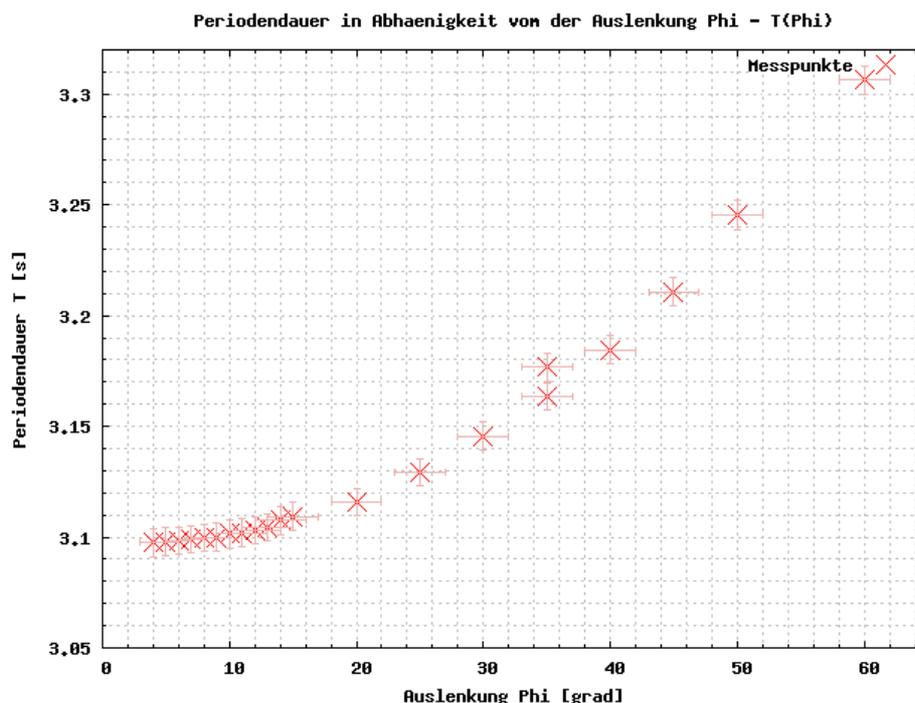
Erkennbar ist der systematische Fehler der Sinus-Näherung, die bei großem Ausschlag stärker ins Gewicht fällt. (Für  $\phi \leq 10^\circ$  ist der Fehler  $\leq 3,6\%$ ).
